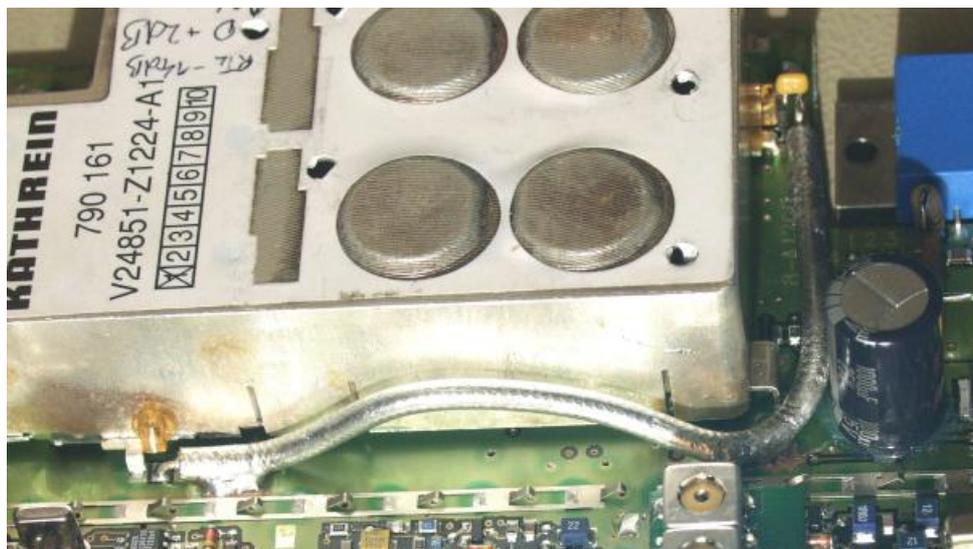
Nachdem die Leitung einigermaßen paßt, kann sie mit dem 100W LötKolben mit der Platine verlötet werden (da wo vorher die Schutzschicht entfernt wurde).
