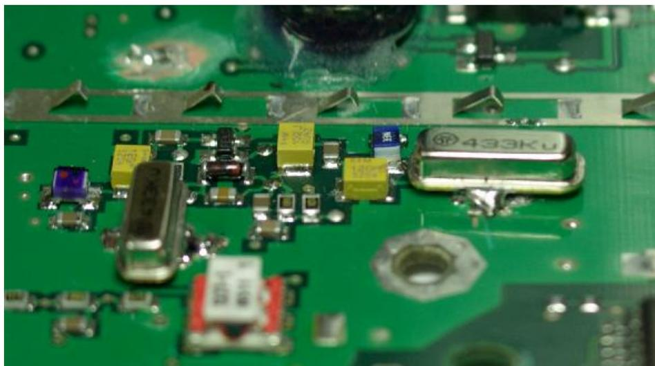
Nachdem man Ein- und Ausgänge von der Unterseite her verlötet hat, wird noch einmal die Lage der Filters überprüft (gerade und im Fall von Z300 max. 4,5mm hoch). Danach verlötet man mit einem stärkeren LötKolben die Massebeinchen flächig auf die Platine.
