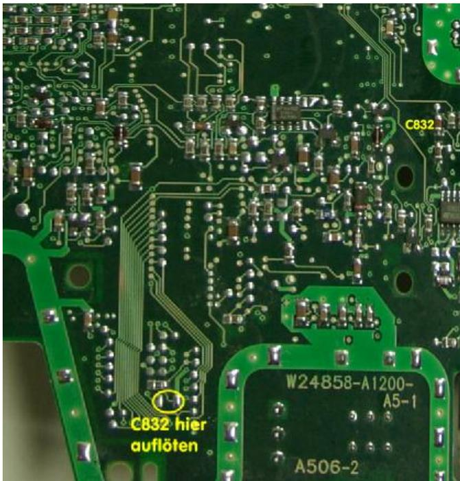
Dieser C befindet sich auf der Unterseite der C5-Platine horizontal mittig auf der Höhe des N800. Im Vergleich mit der Hörermodifikation ergab sich folgendes Bild (Modulation):
